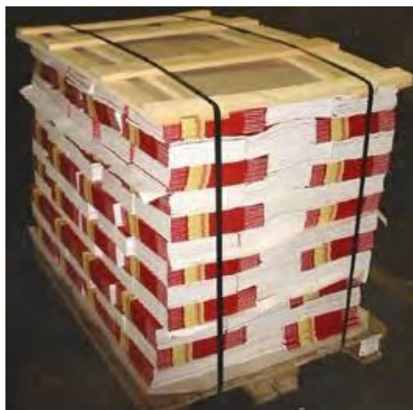
Mit Deckel und Stahlband umreift
