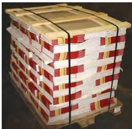
Mit Deckel und Stahlband umreift
